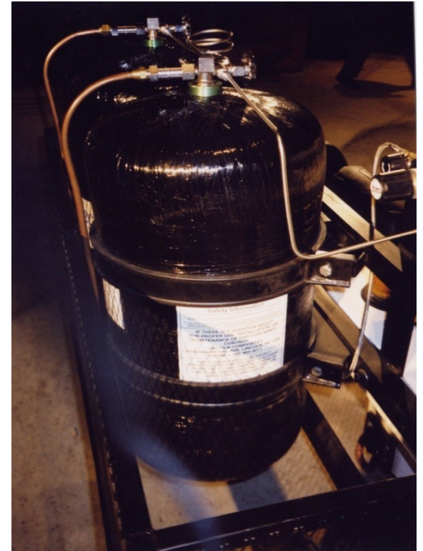
Cilindro de alumínio revestido com fibra de carbono e resina
