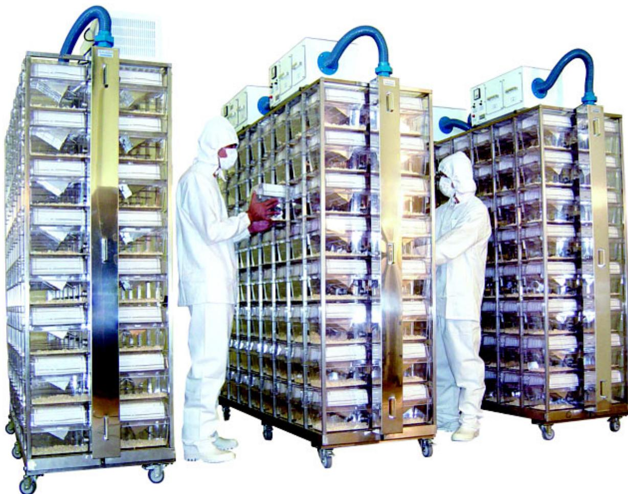
Sistema de microisoladores (*Racks ventilados*)
